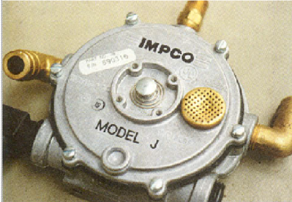
Abb.2 Dieser Verdampfer-Druckregler ist sofort auszutauschen
