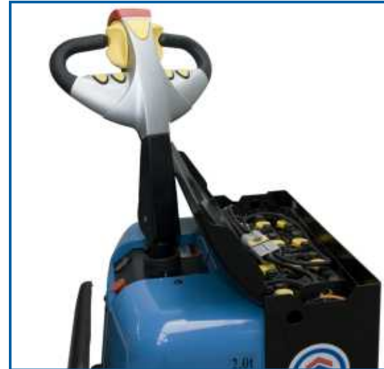
Leicht zugängliche Batterie zum Laden und für Wartungsarbeiten.
