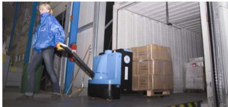
Elektro-Niederhubwagen E-20BF-AC: Zum sicheren Be- und Entladen von LKWS und Containern
