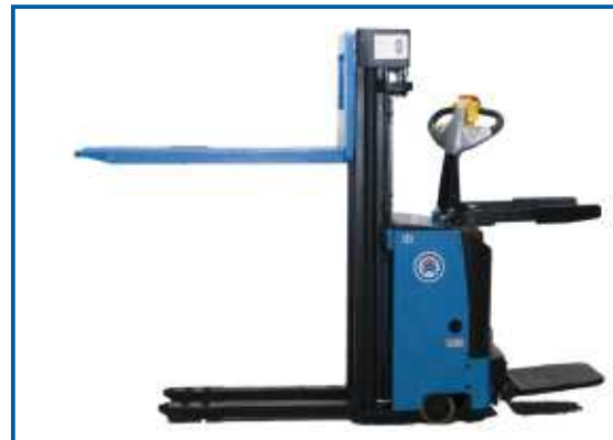
Kompakt, mit einem Freihub von 1695mm passt der E-1534FH durch jede Tür.
